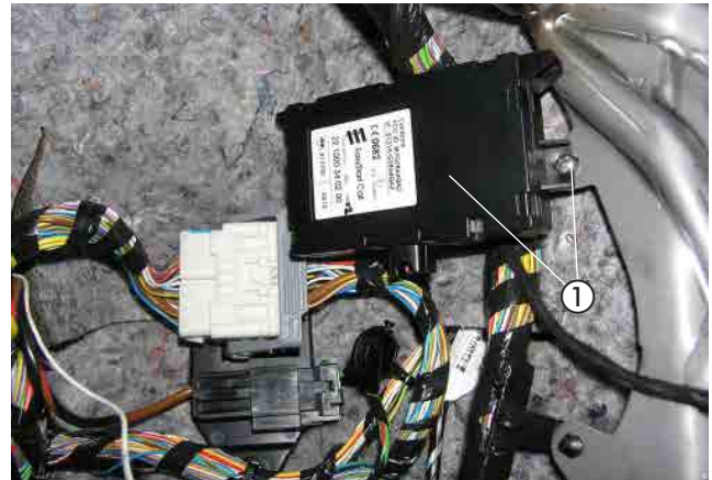
Bilde 13 ① Stasjonærdel for EasyStart Web monteret
