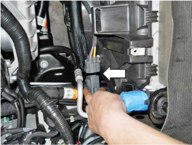
Fan electrical connector
